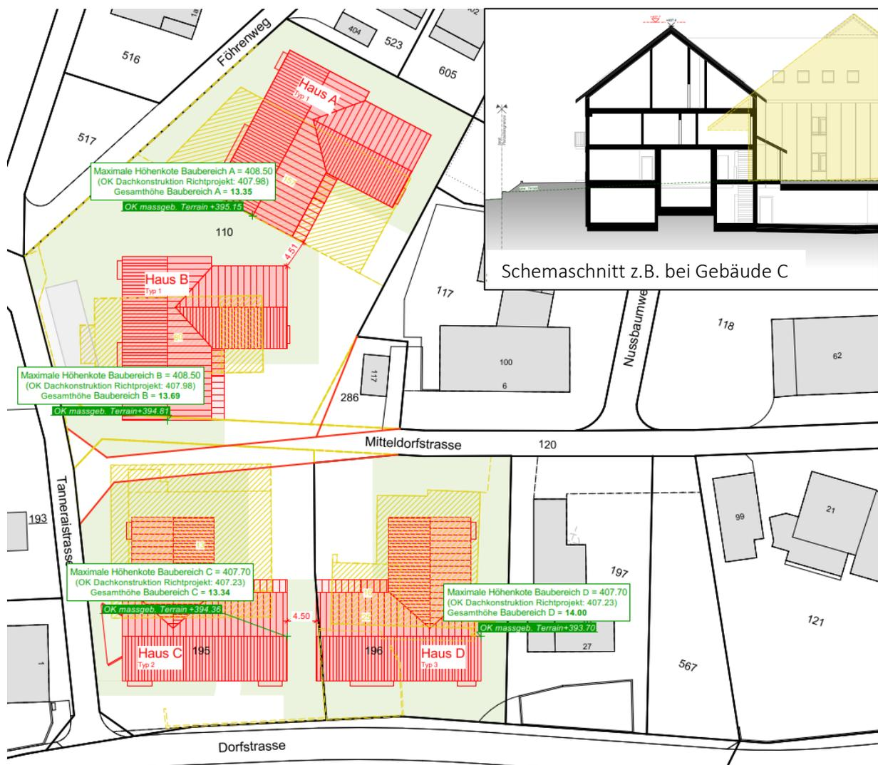
Abbildung 15 Max. Höhenkoten in m ü. M. pro Gebäude im Richtprojekt bzw. Baubereich im Gestaltungsplan
